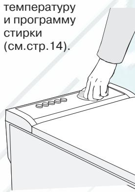
6. С помощью различных кнопок, установите другие возможные режимы и параметры стирки. Нажмите на главный выключатель для того, чтобы запустить машину (см. стр. 10).
